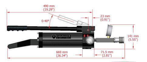
HYDRAULIC SINGLE PORT SEALED HAND PUMP
